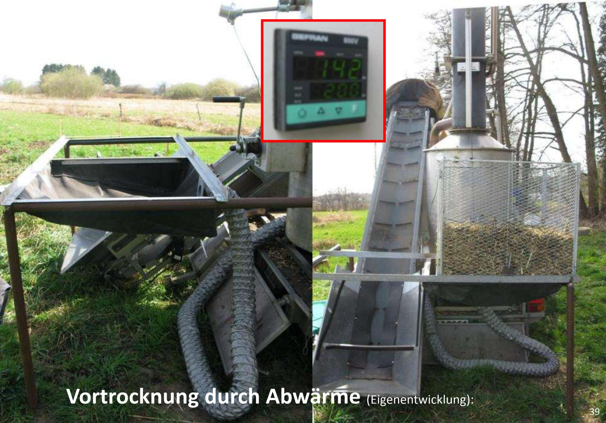
**Vortrocknung durch Abwärme** (Eigenentwicklung):
