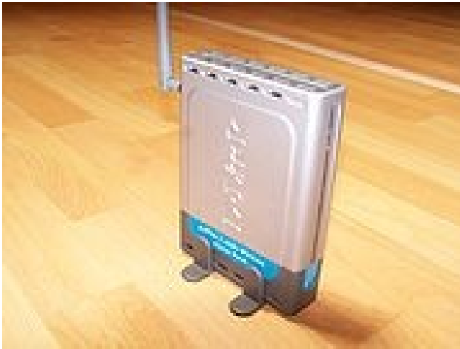
Access Point, einsetzbar als Bridge und Repeater, mit Dipolantenne
