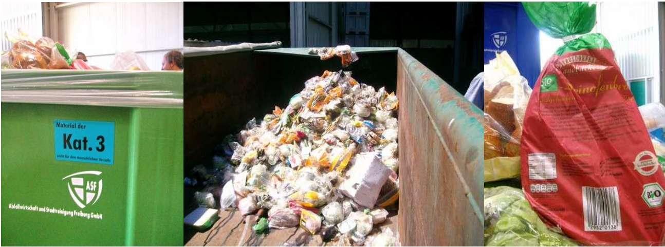
Speiserestecontainer. Für die Supermärkte usw. ist die Entsorgung als Speisereste 1/3 billiger als in Form von Restmüll für die Müllverbrennung. Bisher wurden jährlich etwa 10 000 t Speisereste aus der Region angeliefert. Neu 2010: Vertrag mit einem Discounter.
